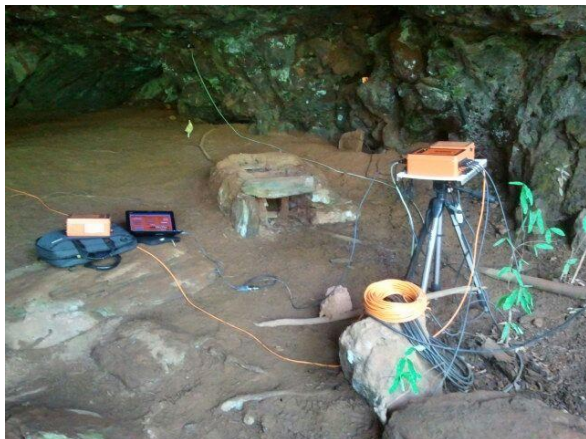
Figura 8. central de armazenamento de dados instalados na proximidade da entrada da cavidade.
