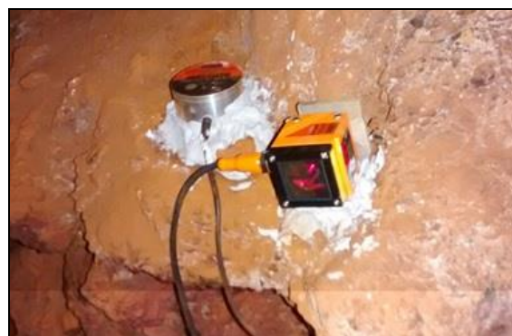
Figura 7. Sensores de vibração - geofone (esquerda) e de deslocamento (direita) fixados com gesso.
