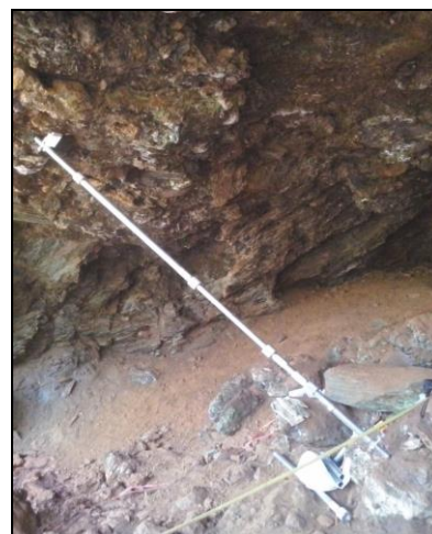
Figura 6. Bloco de canga isolado por descontinuidades instrumentado com a barra telescópica.
